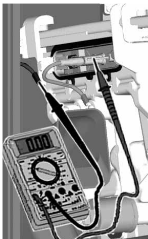
Ionisatiestroom meten figuur 20
